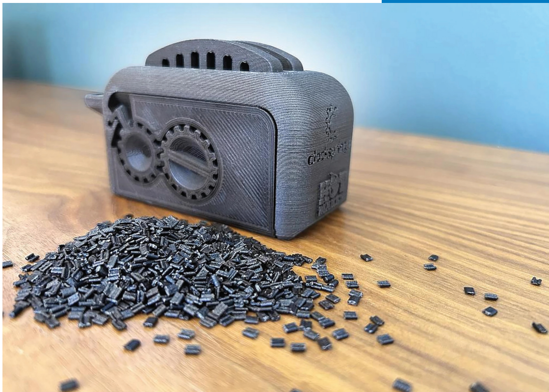
Lignin-reinforced PLA : 30 % lignin for improved properties. Natural antioxidants, higher strength, controlled degradability. PLA ที่เสริมด้วยลิกนิน : ลิกนิน 30 % เพื่อคุณสมบัติที่ดีขึ้น สารต้านอนุมูลอิสระตามธรรมชาติ มีความแข็งแรงสูง ควบคุมการย่อยสลายได้
